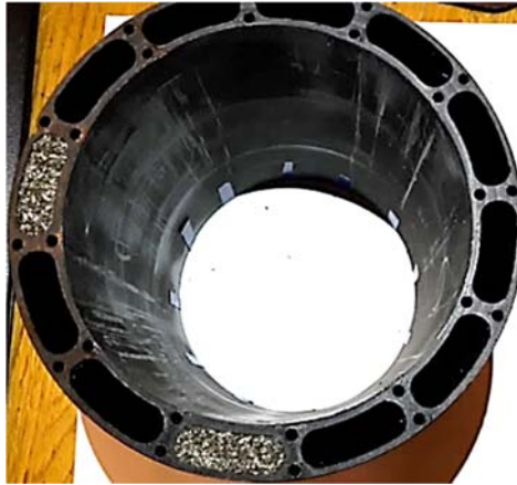
Figur 6: Foto av det cylindriska skalet med kanaler för bäddarna/generatorerna. Två av 12 fyllda i detta läge.
