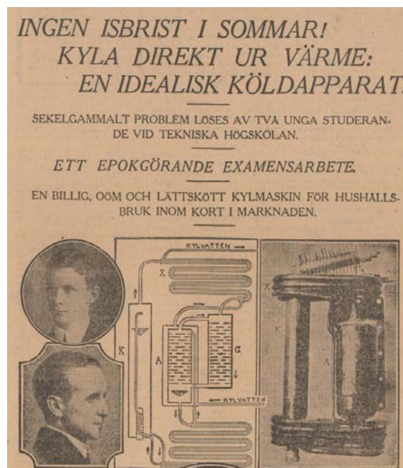
Figur 4: Första presentationen av det absorptionskylskåp som utvecklades av von Platen och Munters och tillverkades av Electrolux
