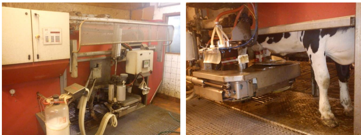
Figur 2: En robot utgörs av ett avancerat system som kan utföra alla de sysslor en bonde annars behöver utföra manuellt vid mjölkning.
