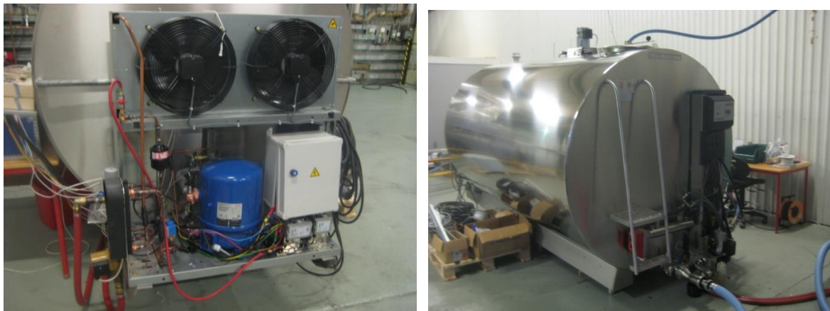
Figur 25: Standard mjölkkyltank med testsystem.
