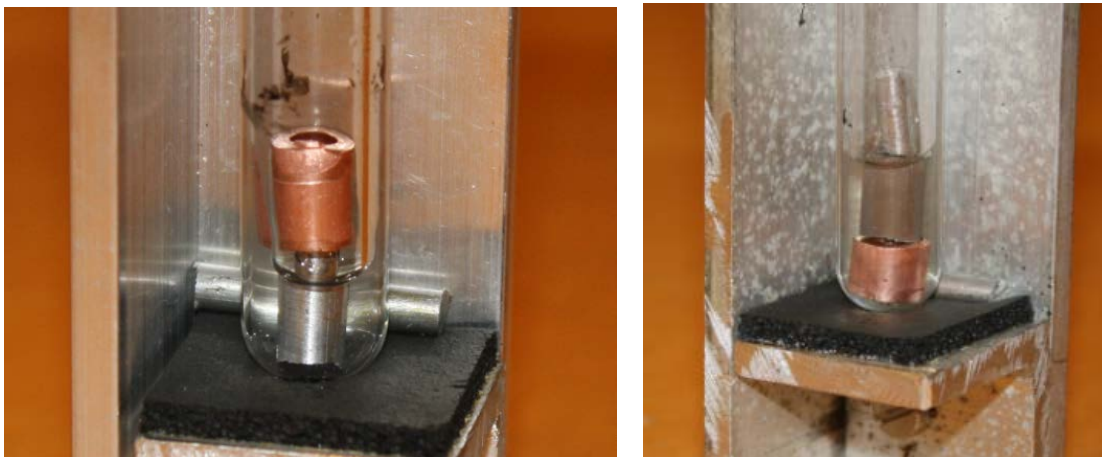
Figur 13: Sealed tube test med bitar av koppar, stål och aluminium i ammoniak.
